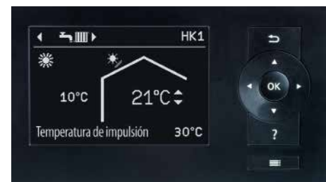
Control del Vitovent 300-C a través de la unidad del regulador de la bomba de calor Vitotronic 200, tipo WO1C
