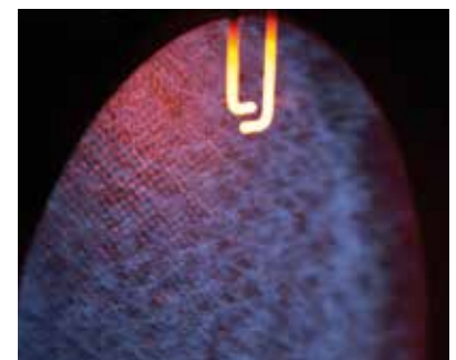
Quemador de disco MatriX-Disk con un rango de modulación hasta 1:6 para un mayor rendimiento energético y un menor nivel sonoro
