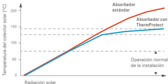
A una temperatura del colector superior a los 75 °C, la emisividad del absorbedor aumenta enormemente, lo cual, en caso de estancamiento, evita de forma fiable el sobrecalentamiento y la formación de vapor.
